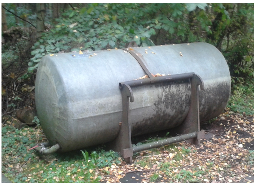
Foto nr. 1 Tank med vand, der benyttes til befugtning af lastbiler og kørearealer.
